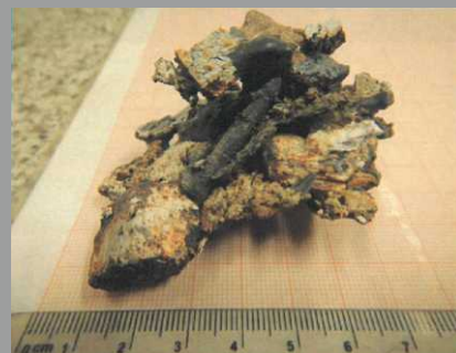
Pobrane do kontroli odpady paleniskowe
